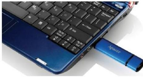
Ο υπολογιστής σας θα εντοπίσει τη συσκευή και θα εμφανίσει το εικονίδιο του προσαρτημένου υλικού (με το πράσινο βέλος επάνω). Θα εμφανιστεί το μήνυμα «Found New Hardware» (Εντοπίστηκε νέο υλικό).
